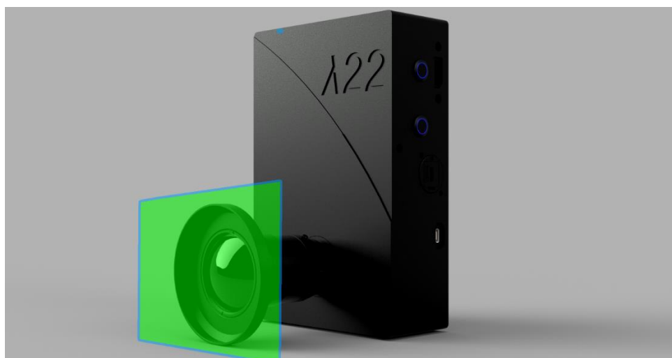
Rys. 2.3. Wizualizacja wycinka płaszczyzny służącej do ustalania odległości pomiędzy kamerą a obiektem mierzonym (kolor zielony)
